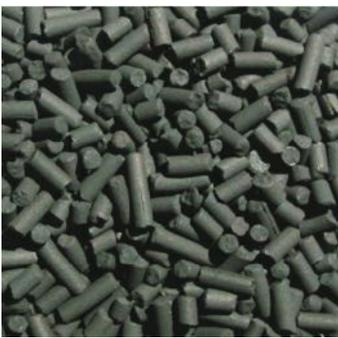
Cuando la presión del gas es suficientemente alta, las moléculas de nitrógeno, argón y otros gases presentes en el aire pasan a través de los poros del CMS a mayor velocidad y son retenidas mediante adsorción selectiva, permitiendo que el oxígeno enriquecido atraviese el filtro molecular al nivel de pureza deseado.
